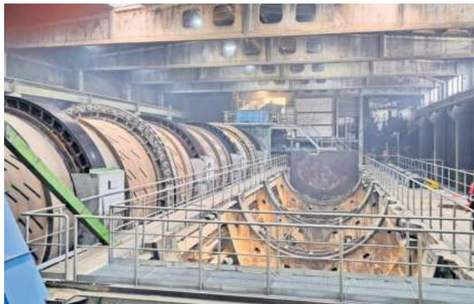
In einer riesigen Drehtrommel werden die angelieferten Baumstämme von ihrer Rinde befreit und anschließend in kleine Stücke gehäckselt.
