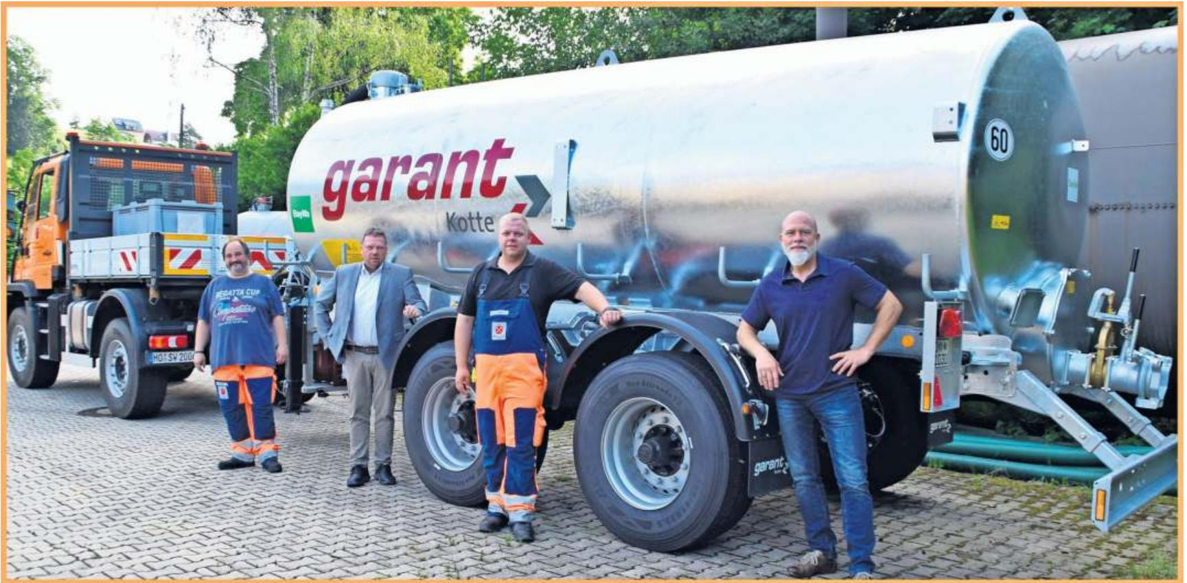
Die Stadt Schwarzenbach a.Wald hat wieder investiert und für die Abwasseranlagen einen neuen Vakuumentankwagen angeschafft. Dieser dient zum Klärschlammtransport und hat ein größeres Volumen als der alte Tankwagen. Das zulässige Gesamtgewicht liegt bei 20 Tonnen, gefahren werden kann bis zu 60km/h. Die Kosten für die Neuanschaffung belaufen sich auf 58.000 Euro.
