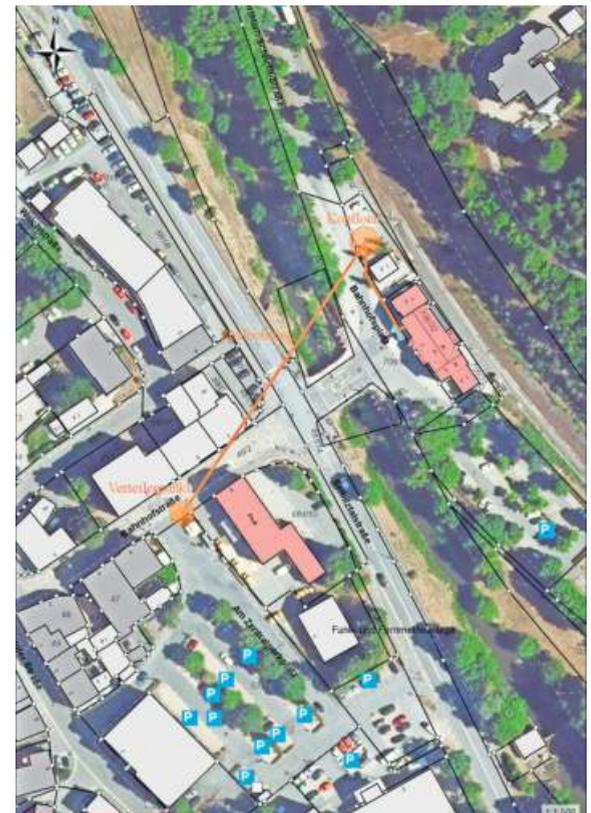
Trassenverlauf der Spülbohrung unter der Selbitz hindurch
