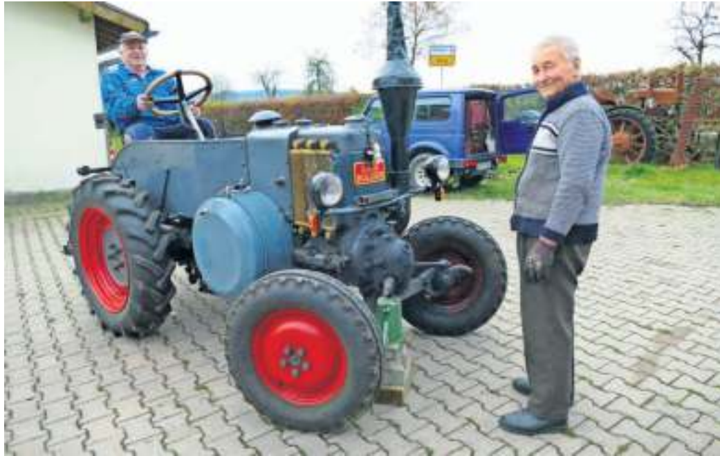
Stolz nimmt Besitzer Manfred Resch auf seinen Lanz Baujahr 1940 Platz, während Rudolf Enders die Lötlampe für das Vorheizen des Glühkopfes im Blick hat. Fachmann und Handlanger haben zwei Jahre geschraubt, um den Oldtimer wieder zum Leben zu erwecken.
